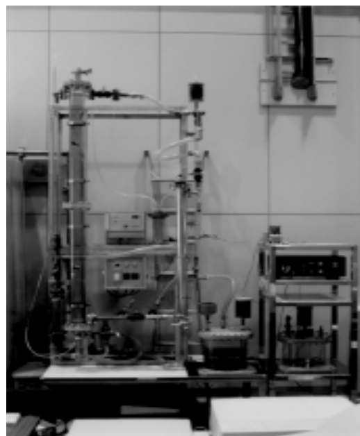
図2 廃水処理ユニット
