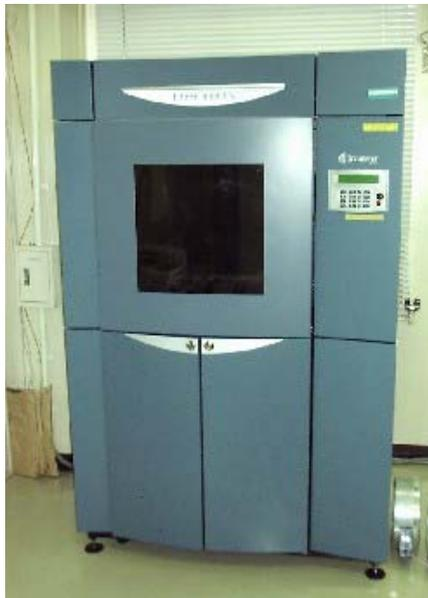
図2 熱溶融積層式 R P 造形装置
