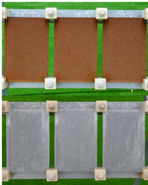
図3 暴露開始2ヶ月後の炭素鋼板(上)と亜鉛板(下)
