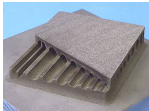
図1 内部に曲がり穴を有する構造物のカットモデル(左：CADモデル、右：造形物)
