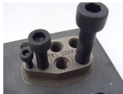
図5 M4、M6、M8のめねじの造形物
