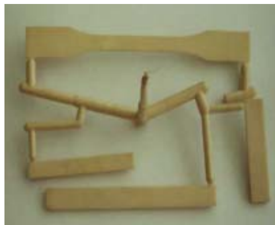
図 試験片のセット取りの例
