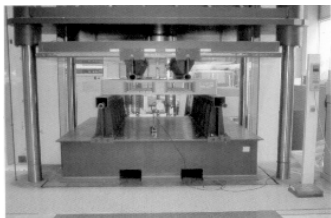
図 1 大型貨物圧縮試験機 (曲げ試験の様子)
