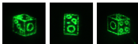
図3 凸型双曲面鏡を用いて再生したサイコロの像
