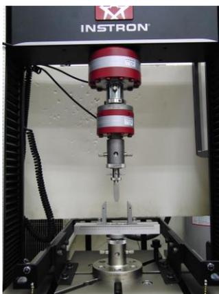
図3 3点曲げ試験モード
