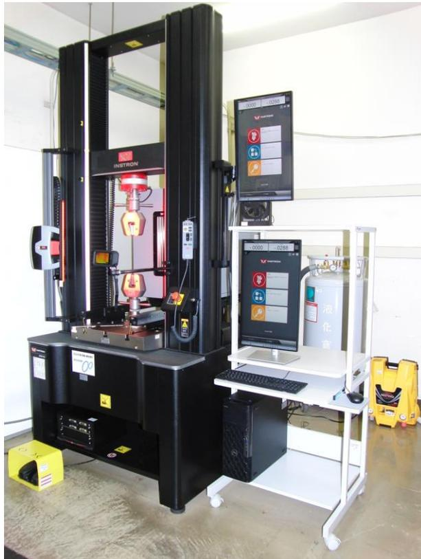
図 1 万能材料試験システムの外観
