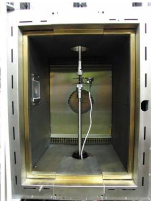
図7 高温環境下での引張試験モード
