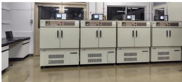
図1 酸素消費量測定システムの外観
