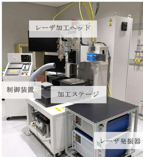
図1 ファイバーレーザー微細加工装置の外観 (LASERX 社製溶接用加工ヘッド搭載時)
