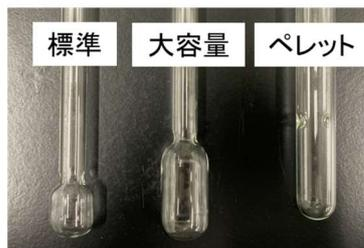
図2 試料管の種類
