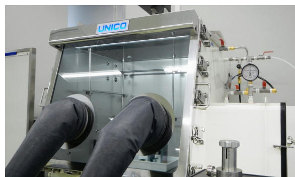
図 2. グローブボックス (内部はアルゴンガス充填)
