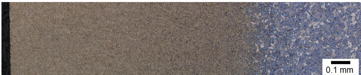
図3 高周波焼入れした軸受鋼 SUJ2 の断面組織パノラマ画像
