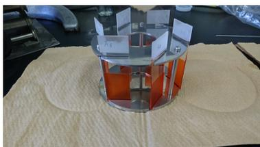
図4 汚垢付着スライドガラスをホルダーにセットした様子
