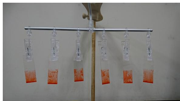
図5 洗浄前スライドガラス(上)とJIS標準洗剤で洗浄したスライドガラス(下)。汚垢が落ちにくい特殊なスライドガラスを使用。
