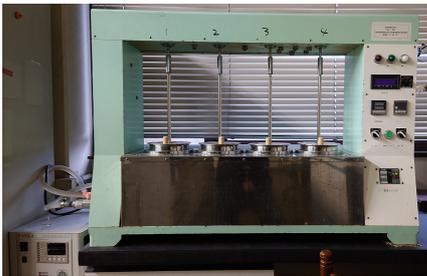
図1 かき混ぜ式洗浄力試験機
