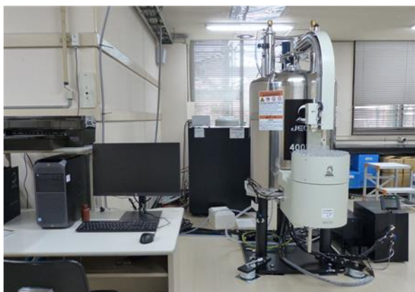
図 1 導入した固体・液体試料測定用核磁気共鳴システム (JNM-ECZ400R)
