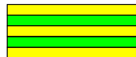
図 2 Ti 箔と Al 箔を交互に積層して SPS により Ti/金属間化合物積層材料を短時間成形
