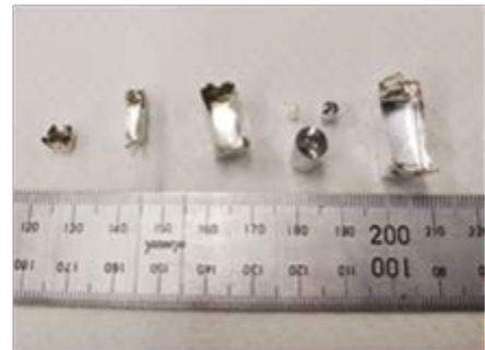
図1 有機元素分析装置の写真(左図：外観写真、中図：オートサンプラー(本体上部)、右図：試料梱包用金属箔)
