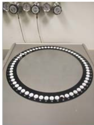
図1 有機元素分析装置の写真(左図：外観写真、中図：オートサンプラー(本体上部)、右図：試料梱包用金属箔)
