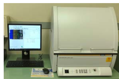
図 2 蛍光 X 線膜厚計の外観
