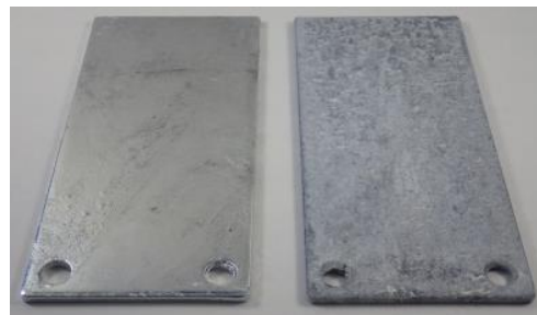
図3 二酸化硫黄ガス腐食試験機(バッチ式)の実施事例写真
