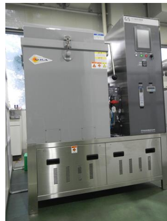
図 1 二酸化硫黄ガス腐食試験機（バッチ式）の外観写真
