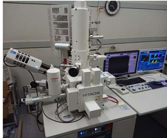
図1 新規導入 FE-SEM の外観写真
