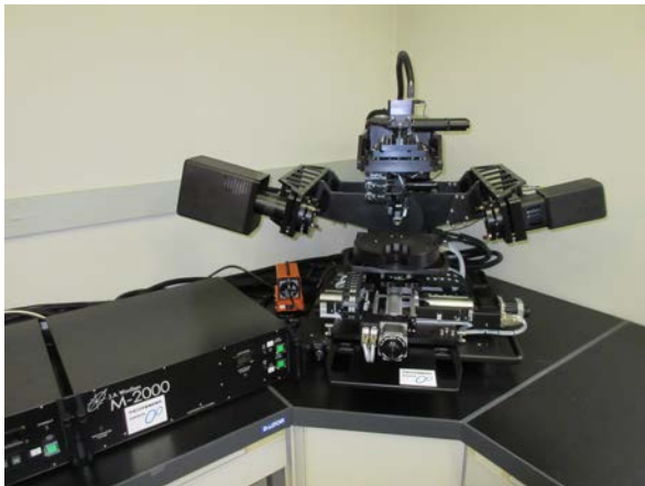
図1. 分光エリプソメーターの外観
