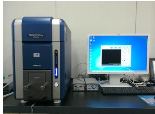
写真 1 低真空走査電子顕微鏡の外観
