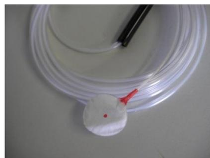
図 4 接触圧力測定装置用エアパック
