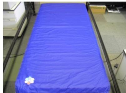
図1 体圧分布測定装置 センサシート部 (ロングタイプ)
