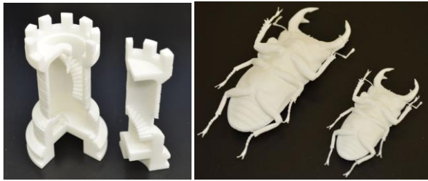
図3 チェスの駒カットモデルとX線CTデータにもとづくクワガタムシの拡大モデル
