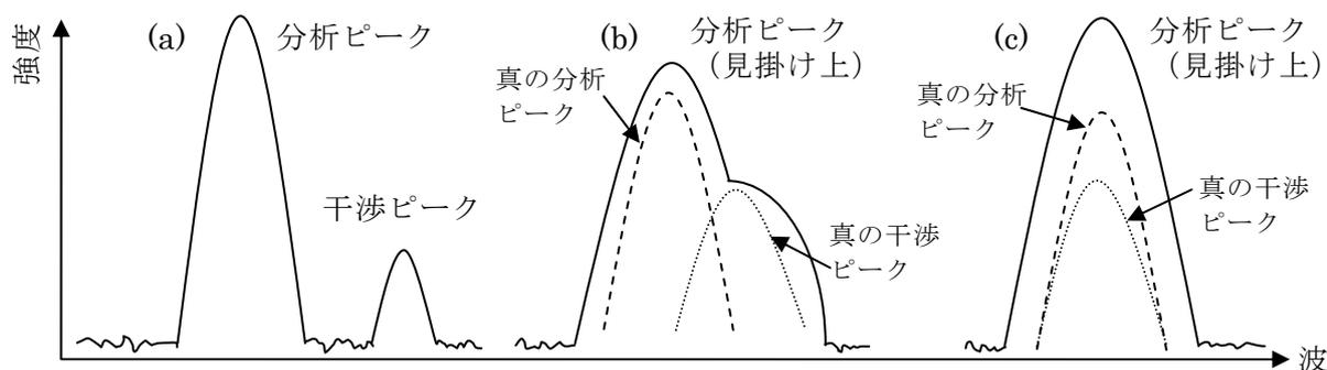
図 1 波長プロファイルに表れる分光干渉パターン (a)分離型、(b)一部重なり型、(c)完全一致型
