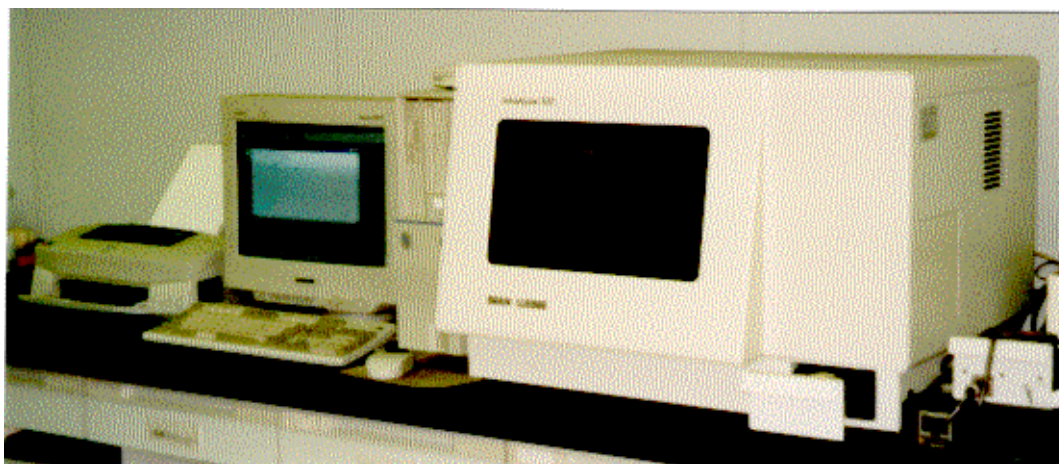
図4 近赤外分光光度計 (ブランルーベ社製 InfraAlyzer 500)
