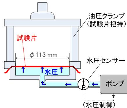
図 1 耐水度試験機の主要部模式図
