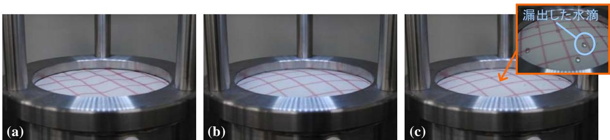
図 2 耐水度試験の状況 (a) 試験片取り付け時, (b) 水圧付与後の試験片の張出し, (c) 漏水発生
