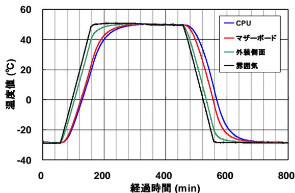
図3 恒温槽を用いた温度変化試験結果
