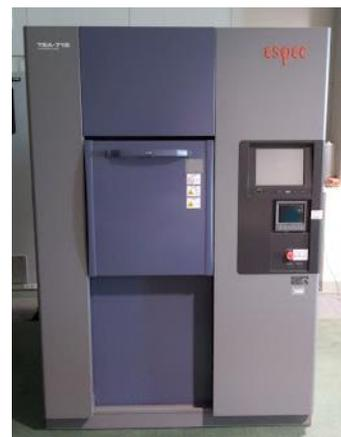
図 2 冷熱衝撃試験装置の概観
