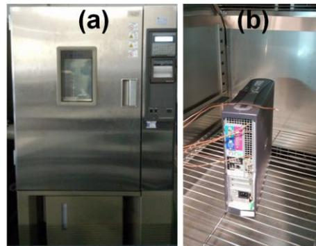
図 1 (a) 恒温槽概観
