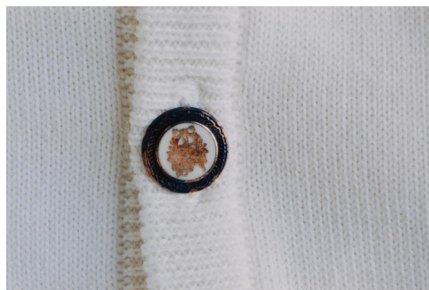
図1 金ボタンの腐食
