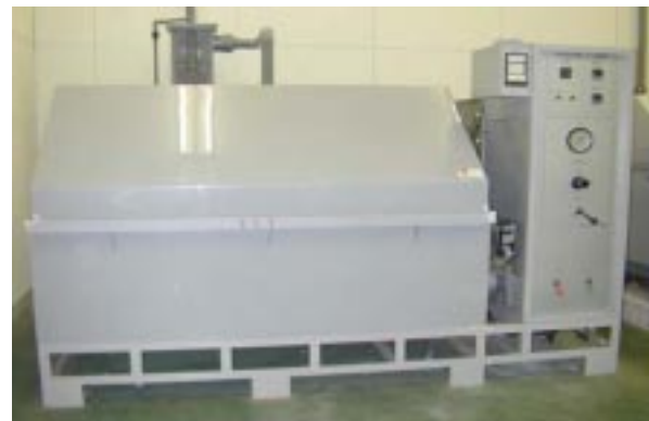
図1 大型塩水噴霧試験機の外観写真
