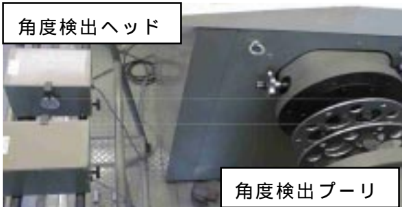
図3 標点間ねじれ角検出装置
