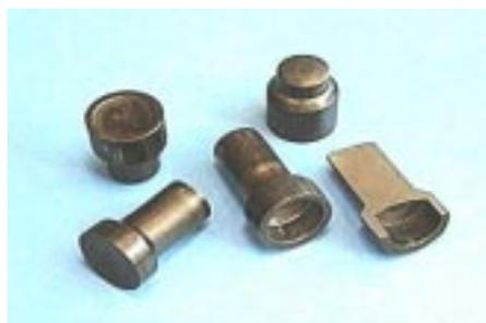
図2 チタン合金の温間押し出し品
