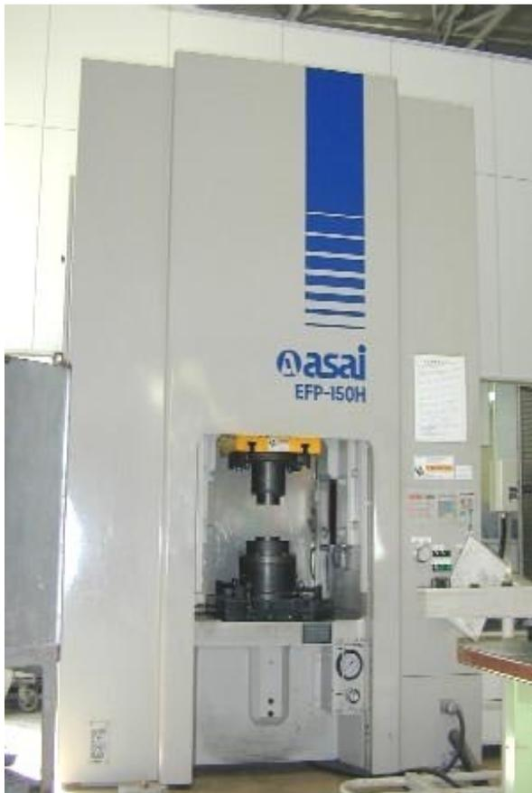
図1 冷温間成形油圧プレスの外観
