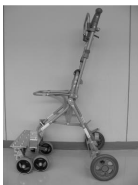
図2 段差乗り越機構付き歩行支援機
