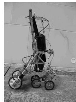
図6 段差乗り越機構付き酸素カート
