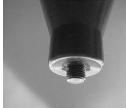
図 2 汎用形状の FSW ツール (ショルダ径は 12mm)
