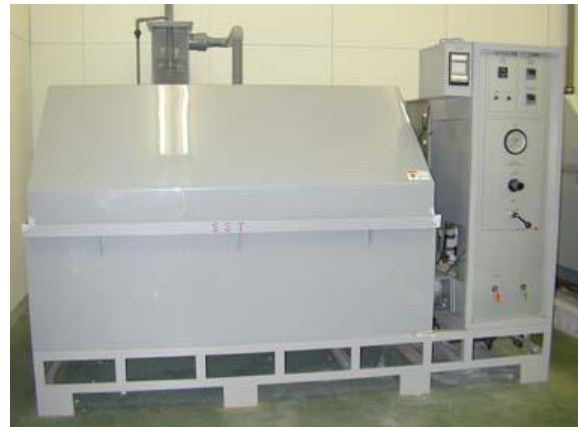
図1 大型塩水噴霧試験機の外観写真
