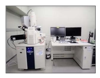
本装置は、像観察や組織解析の分解能や操作性に優れた電子顕微鏡です。本装置は、大電流を安定して照射することができるため分析器等の装備にも適し、それによりサブミクロンオーダーでの高度な材料解析が可能です。また、大型の試料や非導電性試料もそのまま観察することができます。さらに、本装置はリモート機能を有しており、遠隔地から容易に操作することが可能で、会社に居ながらにして、効率的に利用することができます。
