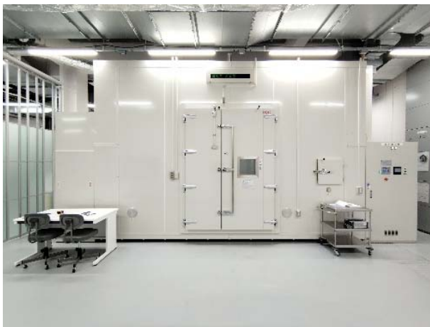
【実測】「空気質評価用大型チャンバー」 横幅：約7m、高さ：約3.6m
