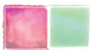
ポラスガラスに担持した新規蛍光体 希土類：左 Eu、右 Tb [両化合物とも、含窒素二塩基酸と結合し、紫外光（254 nm）を照射すると発光する]
