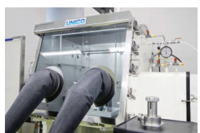
アルゴン雰囲気ですサンプルを取り扱うためのグローブボックス
