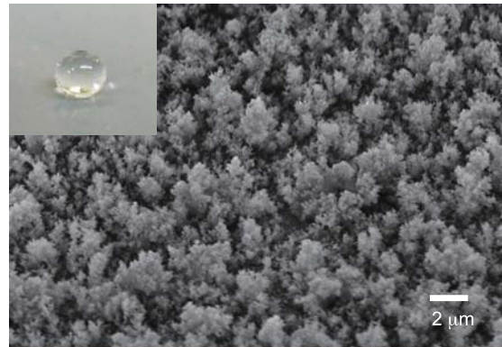
超撥水コーティングの表面電子顕微鏡写真と水滴の様子
