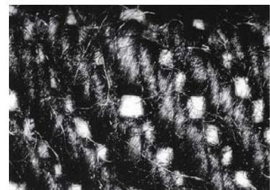
PVA分解酵素を使用せずに糊抜き糸の色が変化し、生地の表面が毛羽立つ
