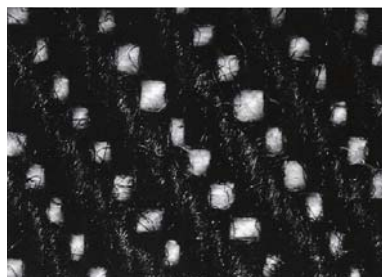
PVA分解酵素を使用して糊抜き糸の色の変化や生地の毛羽立ちがない
