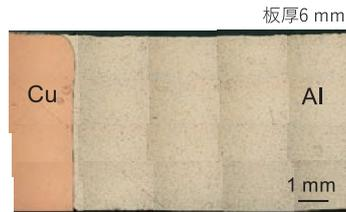
摩擦攪拌接合による銅・アルミニウム接合部の断面
