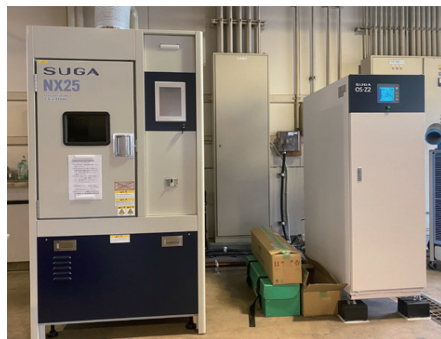
キセノンウェザーメーター (左：本体、右：純水製造機)
