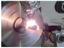
ハイスピードレーザークラディングの様子 回転数400 rpm (周速25 m/min)
