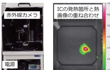
ロックイン発熱解析装置と解析例
