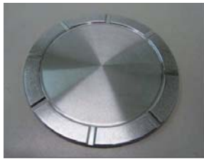
研究開発例：耐食性・耐摩耗性が飛躍的に向上したアモルファスクロムめっき
