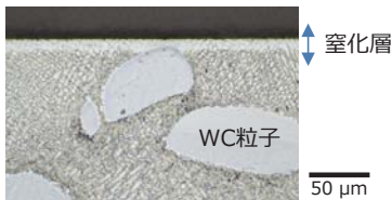
研究開発例：WC粒子複合化ステンレス鋼への低温プラズマ窒化処理
