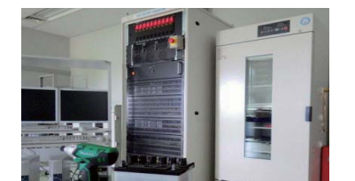
国内公設試験所では当所が唯一所有しています。(DIN 50018) 当所の装置はガス濃度をモニタリングしながら自動制御ができます。(JIS H 8502) (JIS C 60068-2-42)
