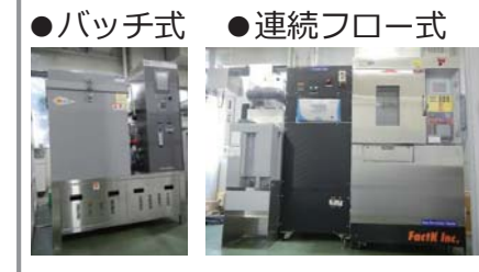
国内公設試験所では当所が唯一所有しています。(DIN 50018) 当所の装置はガス濃度をモニタリングしながら自動制御ができます。(JIS H 8502) (JIS C 60068-2-42)
