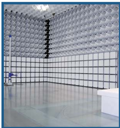
第一電波暗室 (10m 法)
