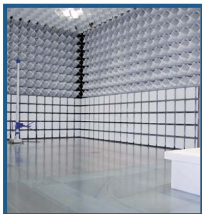
第一電波暗室（10m法）
