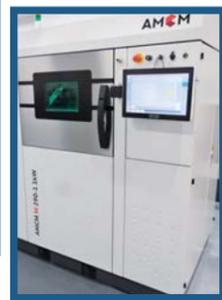
金属 3D レーザ積層造形装置
