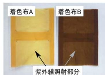
キセノン耐光試験機と紫外線照射試料
