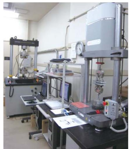
高速試験対応型疲労強度評価システム
