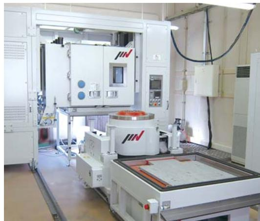
本装置は、一般的な機能として正弦波形やランダム波形そして衝撃波形など様々な振動波形を発生することができ、電気・電子部品、機械製品、自動車や鉄道分野の各種製品、そして輸送中に生じる振動といった幅広い範囲の試験対象に対応が可能です。さらに、温度湿度の設定が可能な恒温恒湿槽を備えているため、さまざまな振動試験に対して温度湿度の制御を伴った複合環境下での耐久試験や、寒冷地を輸送する製品の状態確認や耐久性の評価などを行うことができます。本装置のご利用については担当者にご相談ください。
