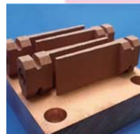
銅合金のレーザ積層造形物
