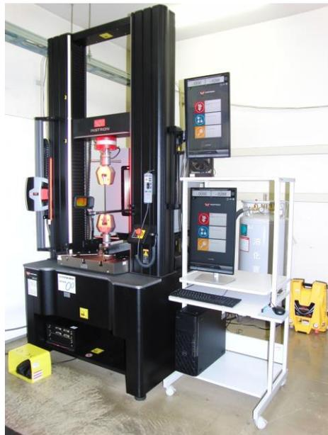
万能材料試験システム 全景
